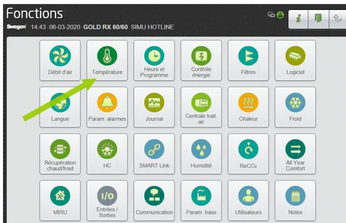
Via l'interface « IQnavigator » (référence TBLZ1711), se connecter de préférence en mode installateur / code : 1111.
