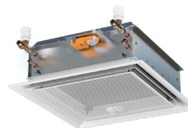
Les régulateurs de nos modules de confort maintiennent une pression constante des buses de soufflage en dépit de la variation du débit d'air primaire, et ce, afin de maintenir un débit d'air induit élevé.
